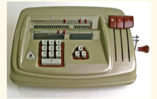
Die Rechenmaschine *Brunsviga 16 T* beherrscht die vier Grundrechenarten. Sie kostet 890 DM und besitzt bereits eine Zehnertastatur mit der heute üblichen Anordnung der Zifferntasten. (Foto: © Arithmeum/Brunsviga AG 1957)
