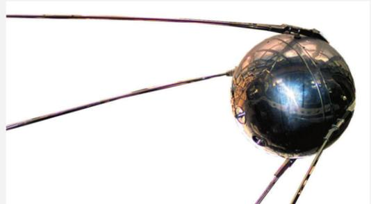
Der von der Sowjetunion gestartete Satellit *Sputnik* fliegt um die Erde. Mit gut einem halben Meter Durchmesser, einer Masse von etwa 84 kg und bis zu 3 Meter langen Antennen schafft er es, Funksignale zu senden und die Erde 1.140 Mal zu umrunden. Mit der *Sputnik 2* wird in November die russische Hündin *Laika* ins All geschossen.
